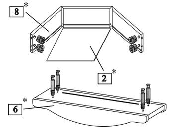
В накладку ящика вворачивается дюбель эксцентриковой стяжки. Ящик складывается согласно схеме, в паз вставляется дно, накладка стягивается с корпусом ящика. **Предварительно просверлив отверстие Ø 2,5 мм**, крепятся направляющие шурупами 4x13. Шурупом 4x16 через фиксатор приворачиваем дно ящика (рис. №7)
