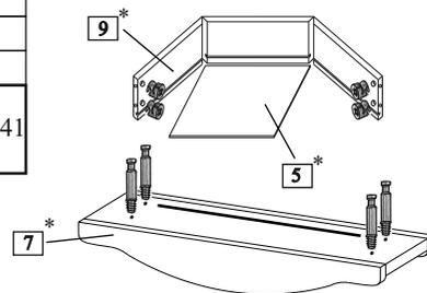
В накладку ящика вворачивается дюбель эксцентриковой стяжки. Ящик складывается согласно схеме, в paz вставляется дно, накладка стягивается с корпусом ящика. **Предварительно просверлив отверстия Ø 2,5 мм**, крепятся направляющие шурупами 4x13. Шурупом 4x16 через фиксатор приворачиваем дно ящика (рис. №6)
